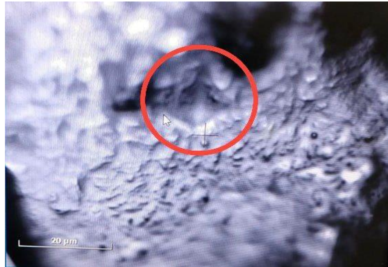
Figure 3.3. Photographie montrant l'empreinte de la pyramide de diamants Vickers.
