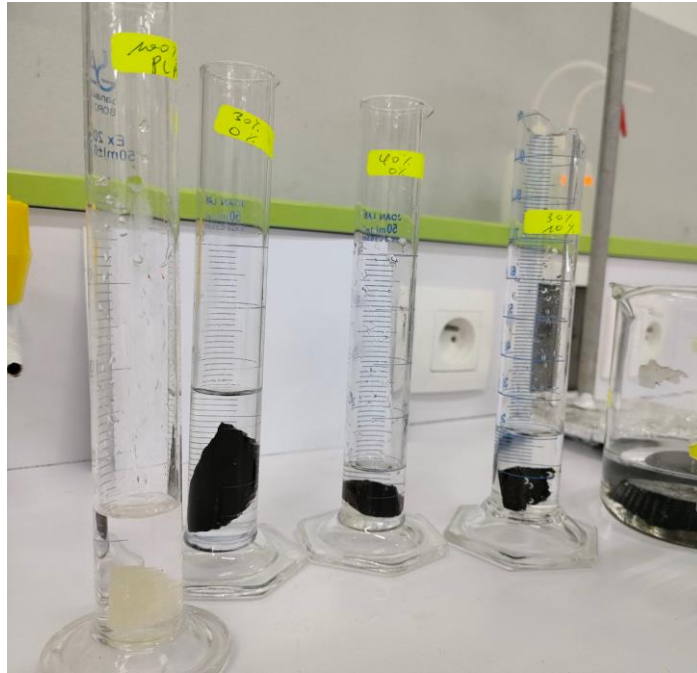
Figure 2.8. Échantillons immergés dans la solution acide.
