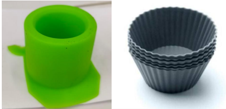
Figure 2.4. Moules en silicone utilisés pour la mise en forme.
