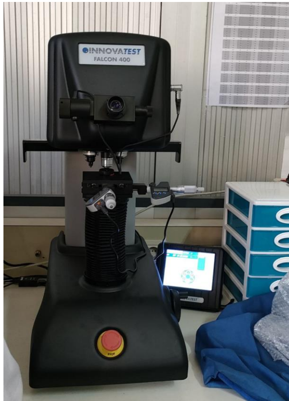
Figure 2.10. Photographie montrant le microduromètre utilisé pour mesurer la dureté du composite.
