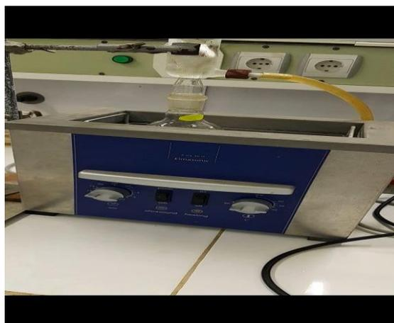
**Figure 2-4 :** L'extracteur bain ultrason
