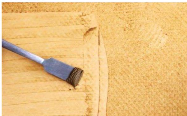
**Figure 3-7:** Photographie de la surface d'un membrane colmaté humide
