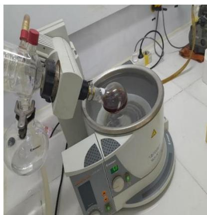
**Figure 2-5:** Elimination du solvant « méthanol » par le rotavapeur
