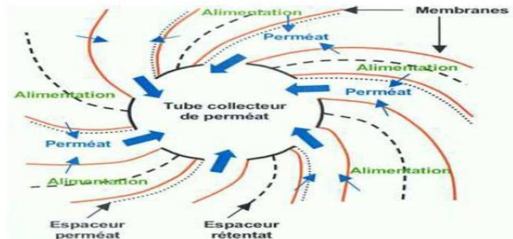
**Figure 1-8:** Principe de fonctionnement d'une membrane spirale vue en coupe [23]
