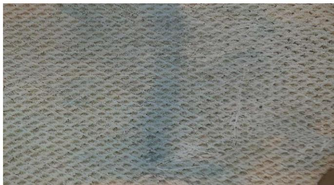
**Figure 3-10:** Test du bleu de méthylène sur la membrane
