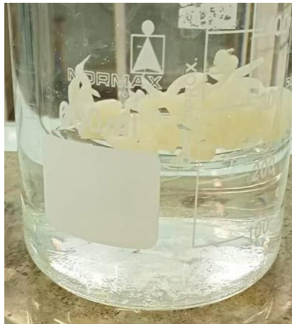
Figure 4.5: Image du gel obtenu d'alginate de sodium et du PE.
