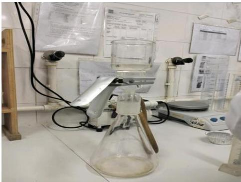
**Figure III.5 Dispositif de filtration sous vide**
