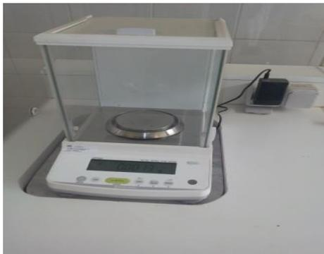
**Figure III.7: La balance de précision**
