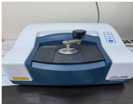
Figure 2.2 : Composition d'un spectromètre FTIR
