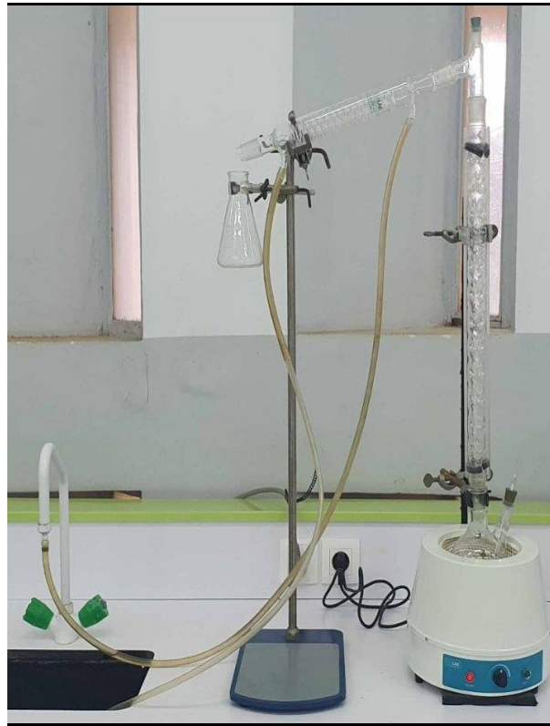
Figure annexe A.2 : Montage d'hydrodistillation
