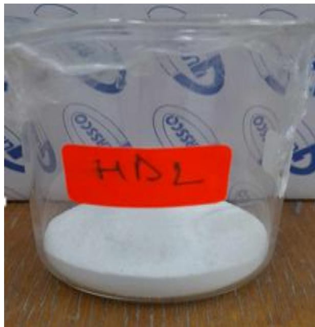
Figure annexe B.7 : Poudre des hydroxydes doubles lamellaires
