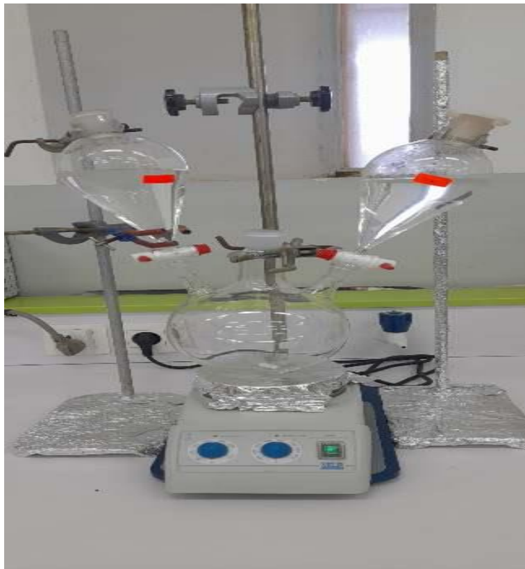
Figure annexe B.2 : Dispositif expérimental de synthèse des phases HDL par co-précipitation directe
