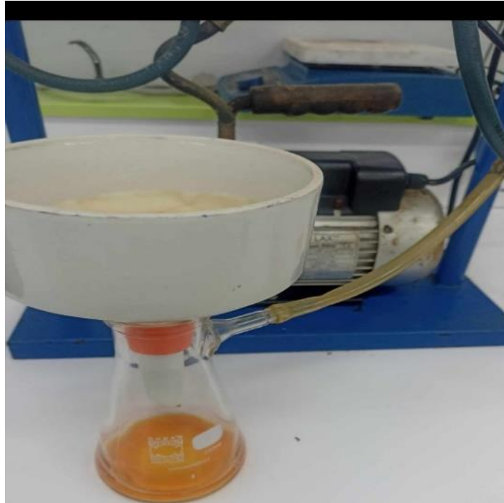
Figure annexe A.4 : Filtration d'extract aqueux
