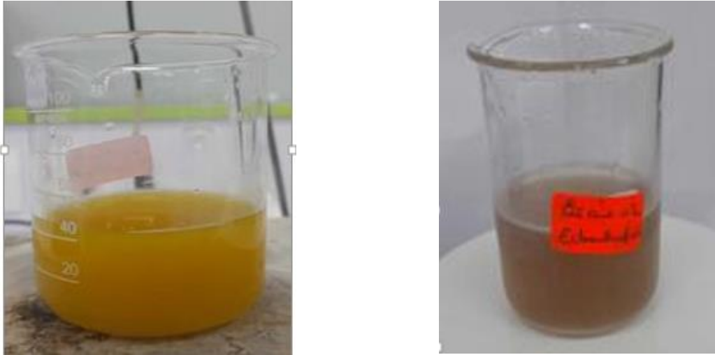
Figure III.23 : Changement de couleur observé lors de la préparation du nanocomposite HDL-AgNPs
