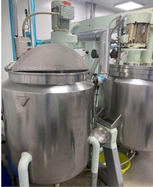
**Figure 1.1 :** Cuve de 200kg
