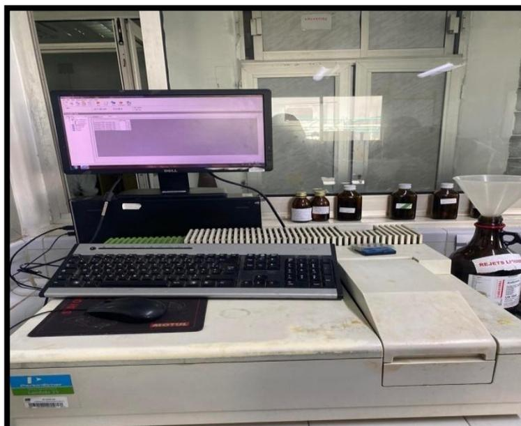
**Figure I .6: Spectrophotomètre d'absorption UV-Visible.**
