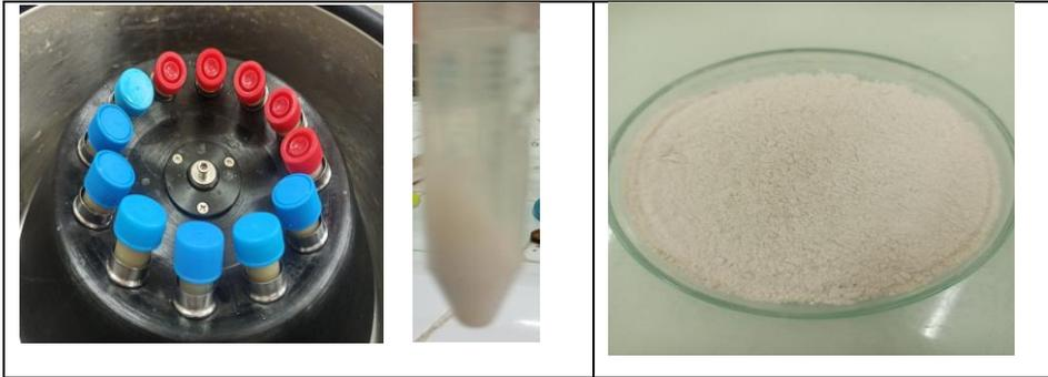
Figure 2.5 : Nanocellulose CTAB préparée. (a) après centrifugation, (b) après séchage.
