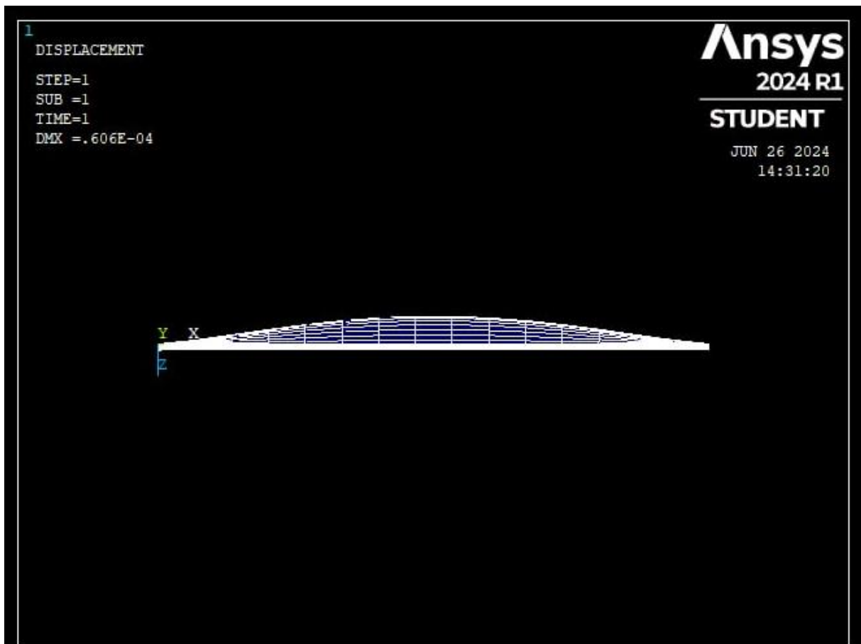
Figure V.10 : déflexion de la plaque a 100 pa et 0v
