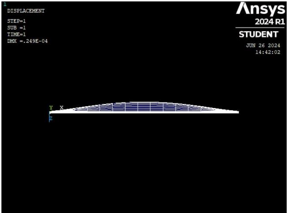
Figure V.11: déflexion de la plaque à 100 Pa et 5v
