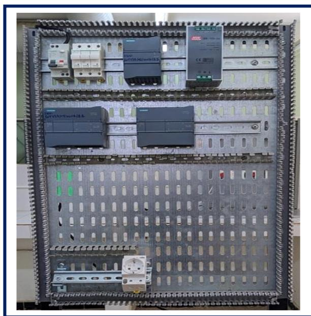
Figure 79 : L'armoire avant câblage
