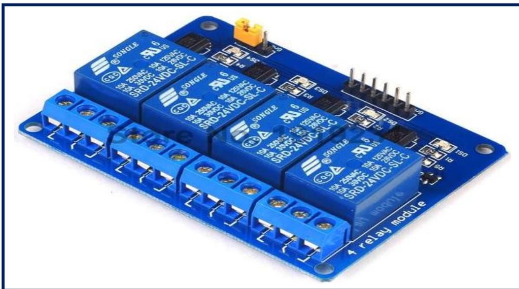
Figure 41 : Module relais à 4 canaux
