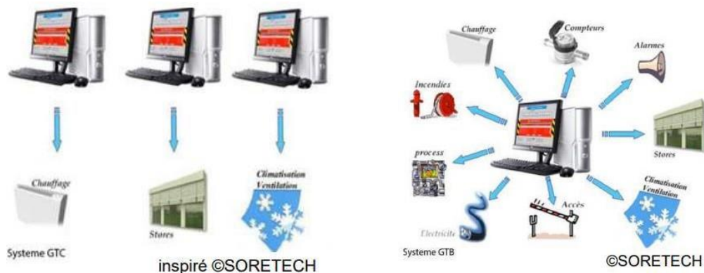
Figure (V.7) : Schéma explicatif des solutions GTC et GTB [34]
