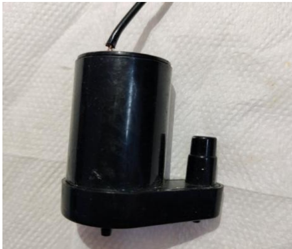
Figure 3.14 : Pompe à eau
