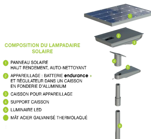
Figure (II.3) : Les composant de luminaire solaire. [8]
