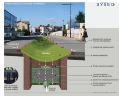
Figure 82: Schéma de récupération des eaux pluviales.
