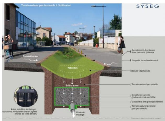
Figure 87 : Schema de recuperation des eaux pluviales . Source : (Des Solutions Pour Les Infiltrer – SYSEG, n. d.)
