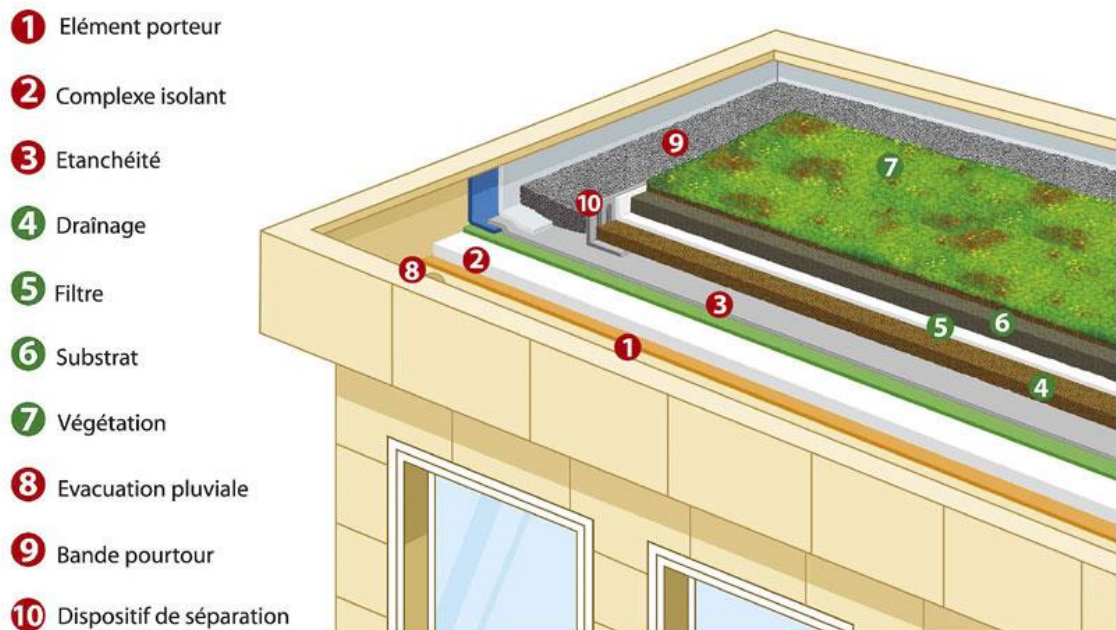
Figure 27: Coupe de principe d'une toiture végétalisée.
