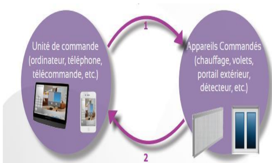
Figure 34:Principe de fonctionnement de la domotique.
