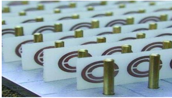
Figure 25 : Première structure de méta matériaux, constituée de fils fins (Thin Wires ‘TWs) et des RAFA [7].
