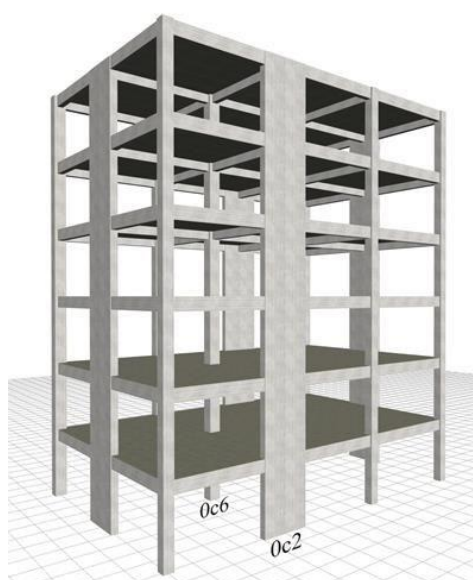
Figure 203: Système poteau poutre
