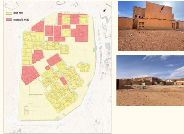
Figure 113 carte représente l'état de bâti existant ksar Hamrayat source : Google Earth modifié par auteur
