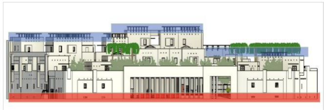
Figure 90 Traitement du soubassement et du couronnement (façade nord)
