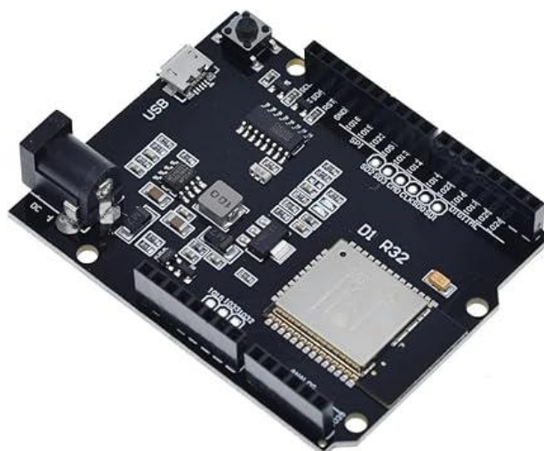
Figure 3. 3: carte développement D1 R32(esp32)
