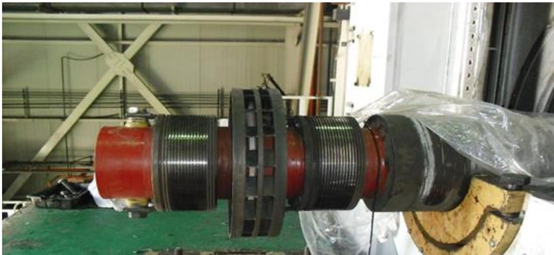
**Figure 1.13** : Bagues collectrices de l'alternateur. [6]
