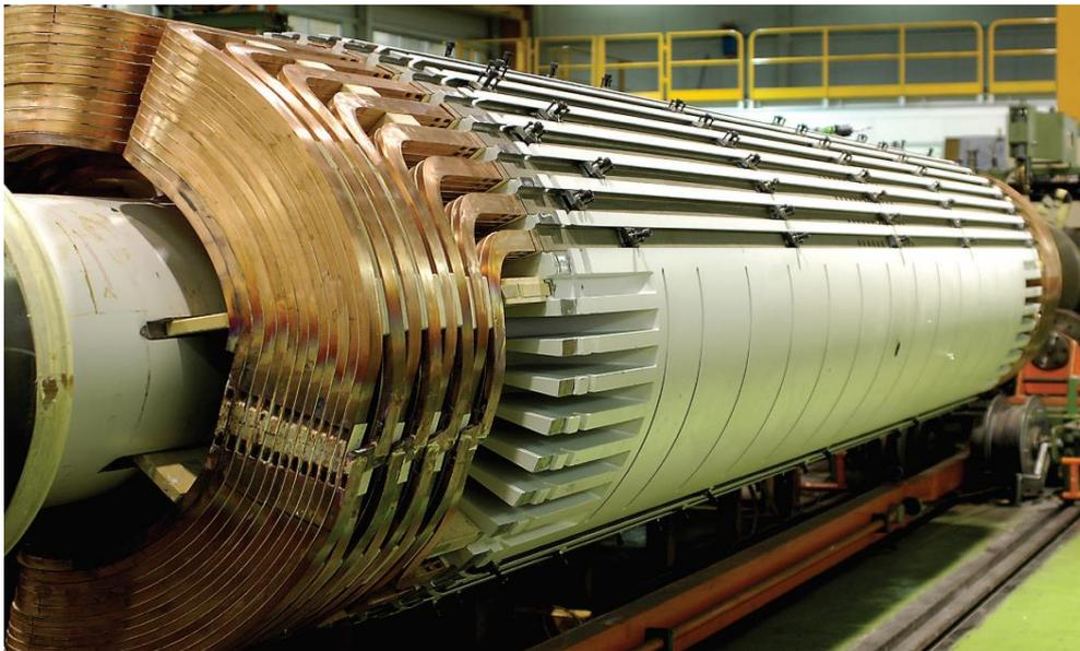
**Figure 1.10** : La partie mobile de la machine. [4]
