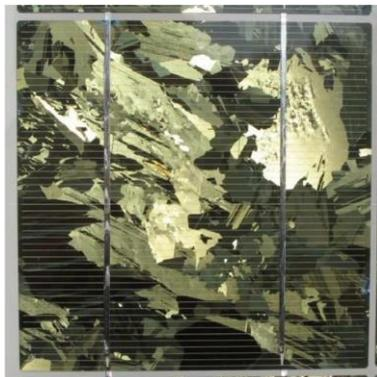
**Figure 1.5.** Cellule en silicium Ploy-cristallin [6]
