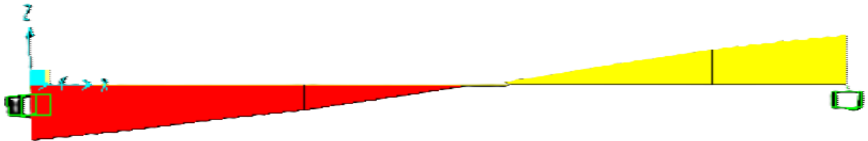
Figure III.8 : Diagramme de l'effort tranchant d'escalier à l'ELU.
