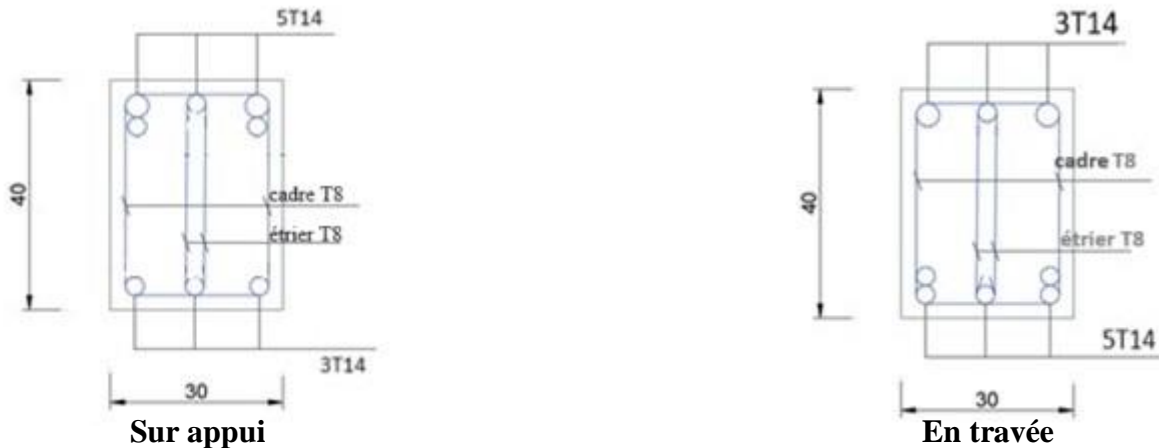
Figure V.4 : Schéma de ferrailage de la poutre secondaire.
