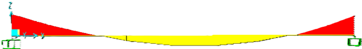
Figure III.9 : Diagramme du moment fléchissant d'escalier à l'ELS.
