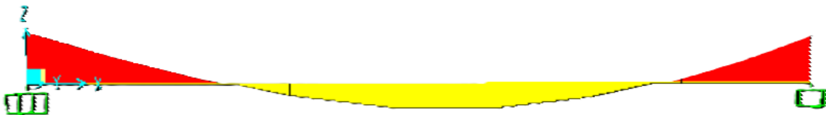
Figure III.7 : Diagramme du moment fléchissant d’escalier à l’ELU.
