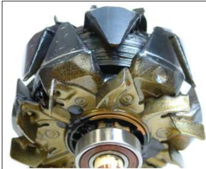
Figure 1.14: Refroidissement par ventilations.
