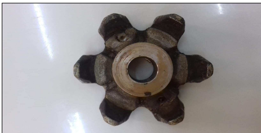
Figure 6 : La roue polaire de rotor de l'alternateur à griffe.
