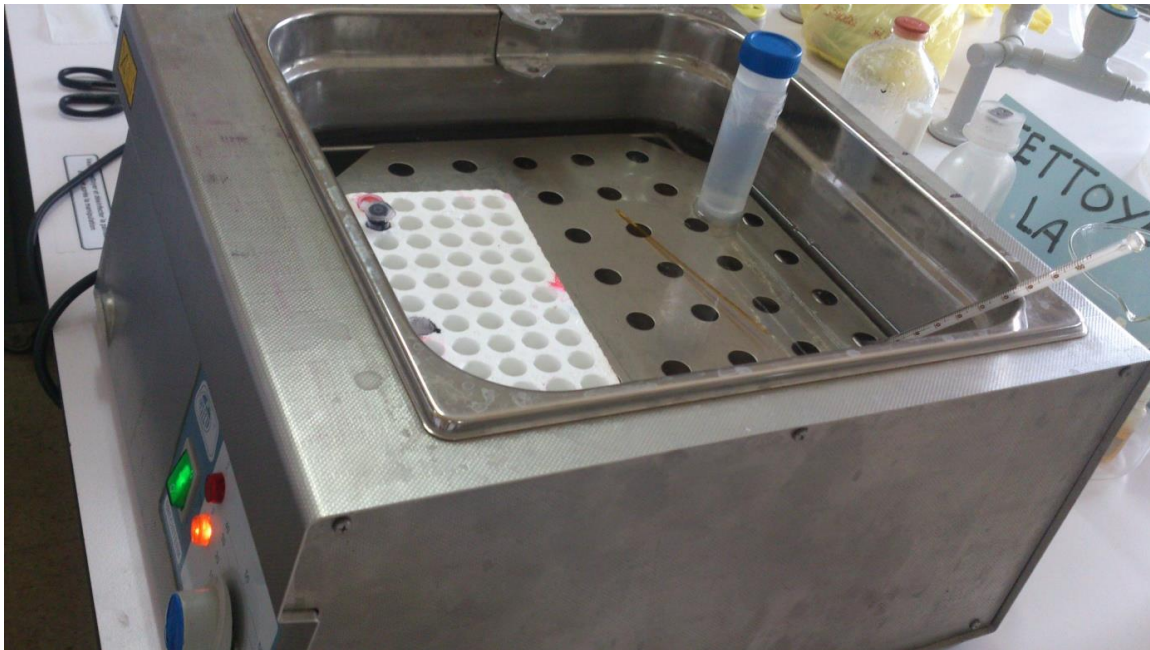
Figure 7. Décongélation des paillettes dans un bain marie et une température de 37°C (Photo personnelle)
