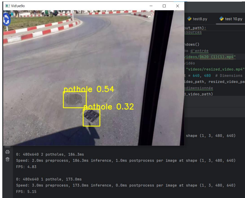
Figure 4.35 : deux nids-de-poule encadrés avec une confiance de 54% et 32%
