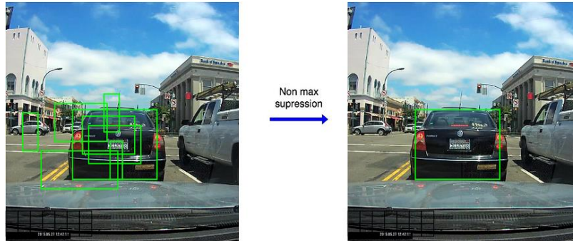
Figure 3.6 : Application de la suppression non maximale (Non Max Suppression) pour la détection d'objet
