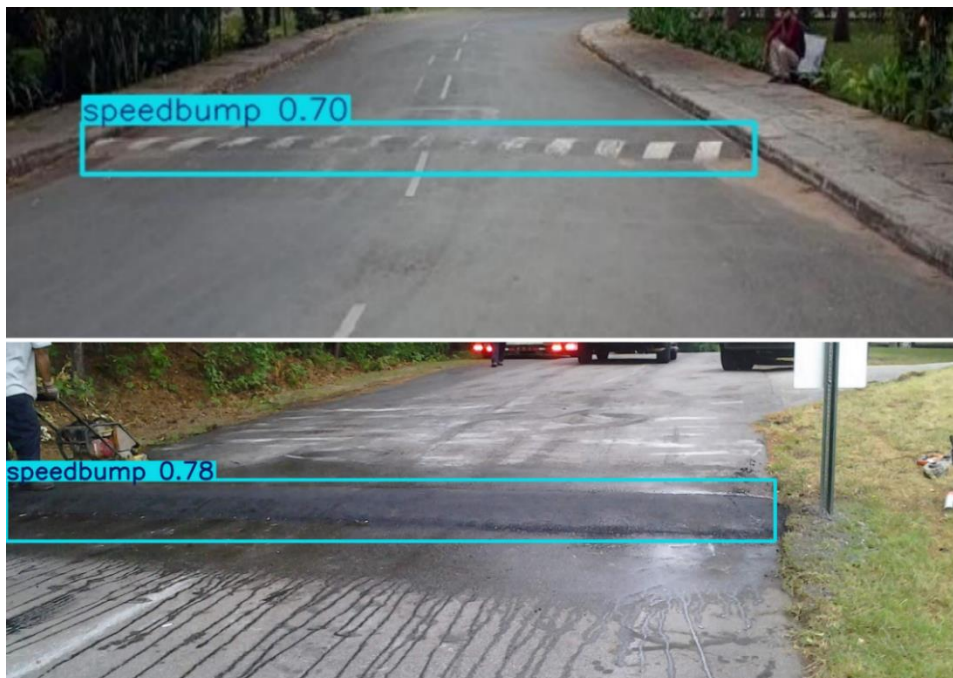
Figure 4.24 :images tests de détection des ralentisseurs non marqués et de peinture fanée.
