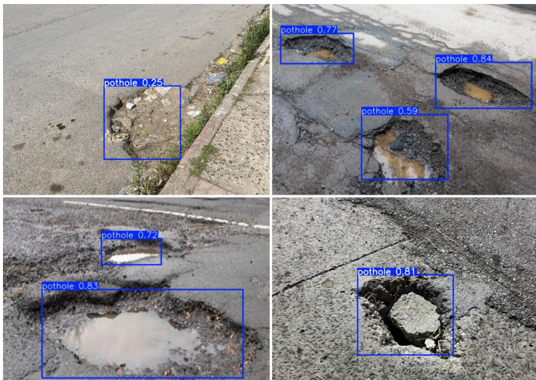
Figure 4.26 : images tests de détection des nids-de-poule remplis d'eau de pluie et secs.
