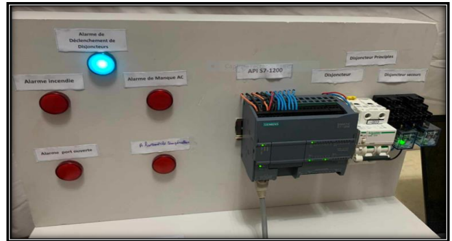
c) Simulation pratique : voyant de manque DC allumé.
