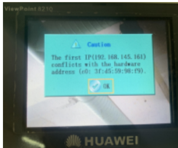
FIGURE 4.10 – Conflit d’adresse IP du hardphone IP
