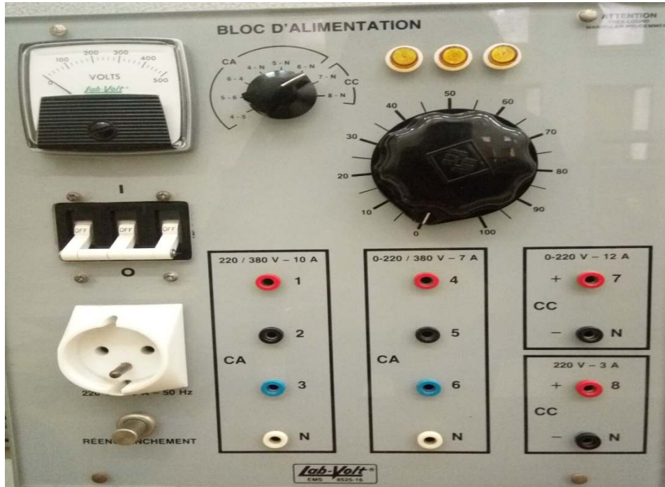
Figure 4.3 : Représente bloc d'alimentation
