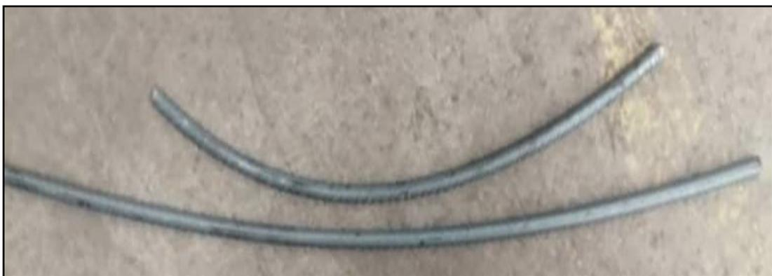
Figure III-11: Défaut d'ondulation.
