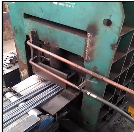
Figure II-25: Cisaille à froid de 12 m.
