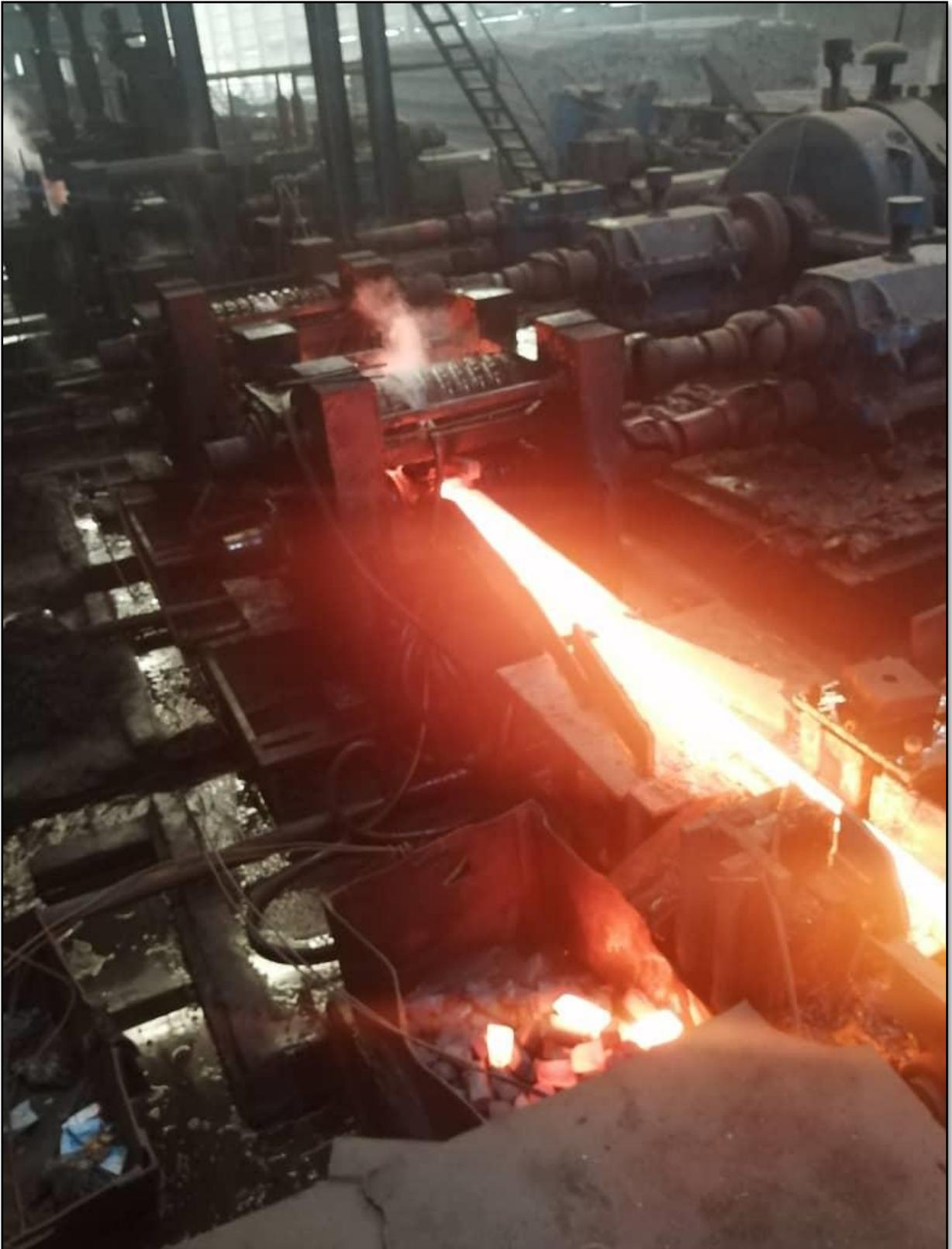
Figure II-18: train de laminage
