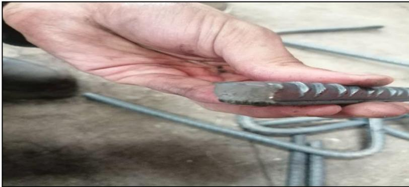
Figure III-8: Hors tolérance diamètre.
