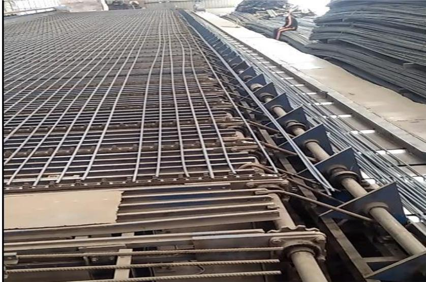
Figure II-24: Système de refroidissement à l'air (COOLING BED).
