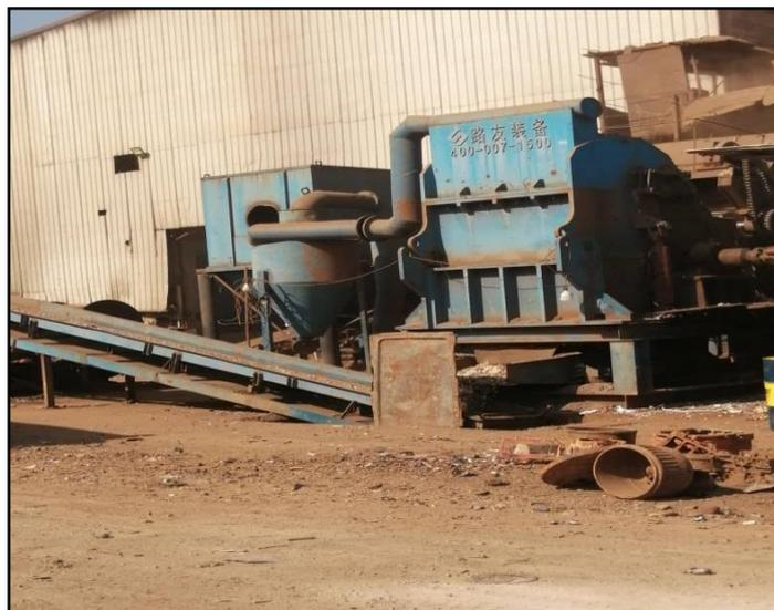
Figure II-9: Le Broyeur
