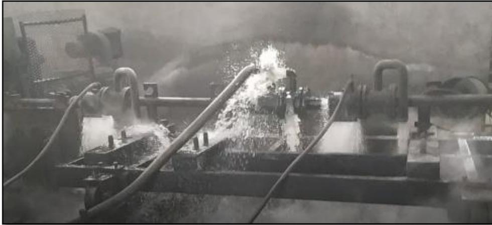
Figure II-22: Système de refroidissement accéléré
