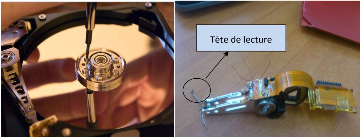
**Figure III.5** l'ouverture d'un disque dur Récupération sa tête de lecture
