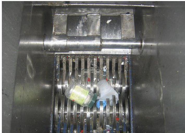
**Figure I.5:** Broyeur pour le verre
