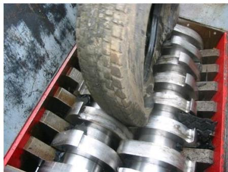
**Figure I.3:** Broyeur à couteaux
