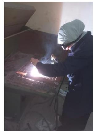
**Figure IV. 28:** Soudage de la structure
