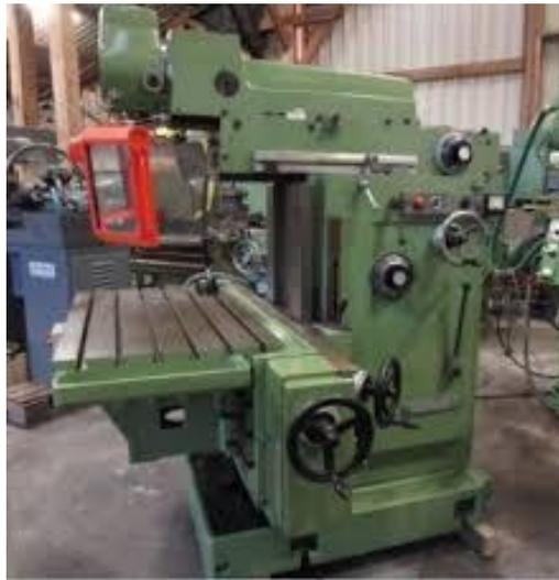
**Figure IV. 7:**Fraiseuse conventionnelle
