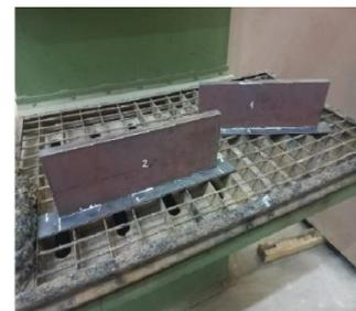
**Figure IV. 19:**Traçage et découpage des plaques
