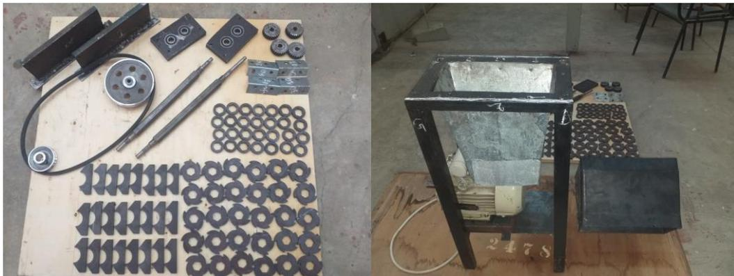
**Figure IV. 33:**Pièces du broyeur désassemblée
