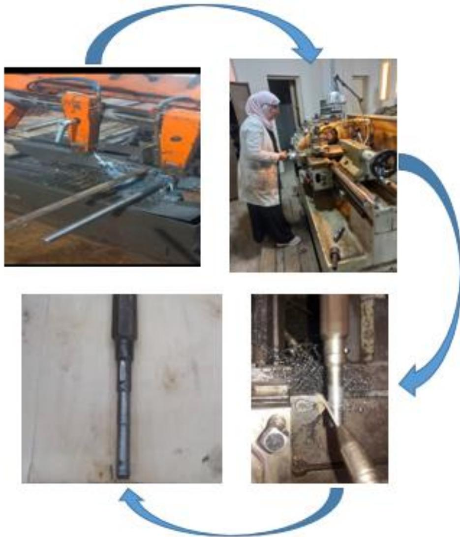
**Figure IV. 16:**Processus de réalisation d'un arbre
