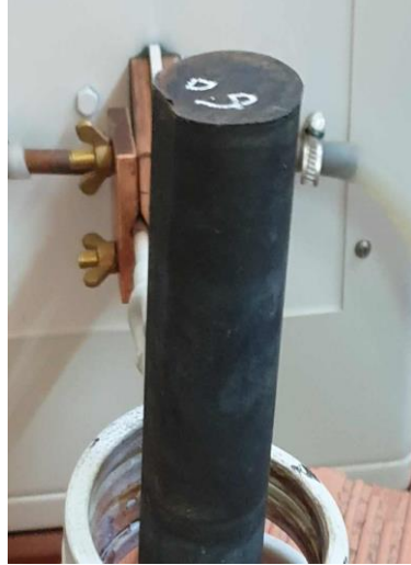
Figure 2.7 : Barreau d'acier soumis au chauffage par induction.
