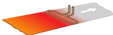
Figure 1.14 : Bobine d'épingle à cheveux [3]
