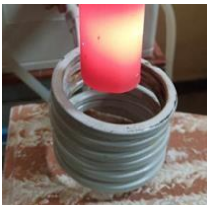
Figure 3.2 : Serpentin choisi pour le chauffage inductif de l'acier A60.
