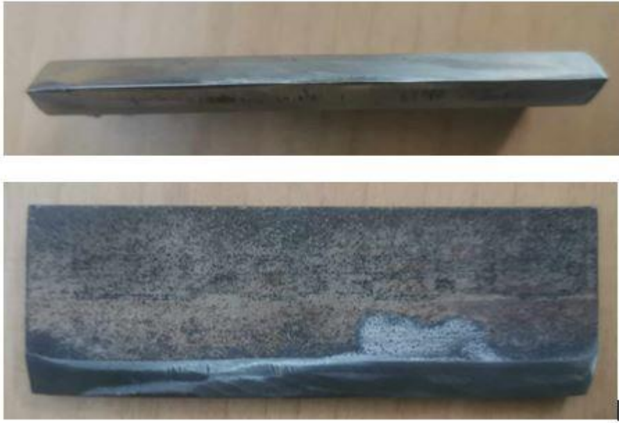
Figure 2.4 : Couteau fait d'acier K100 en forme biseautée
