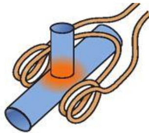
Figure 1.10 : Bobine à hélicoïdale fendue [3]
