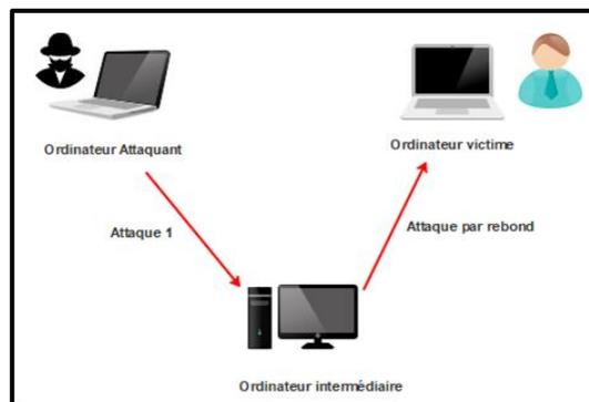
Figure 2-2 : Attaque indirecte par rebond.
