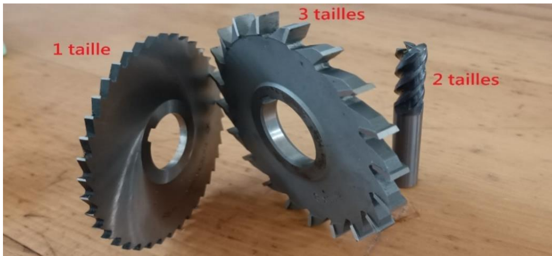
Figure I- 5 : Les tailles des fraises.
