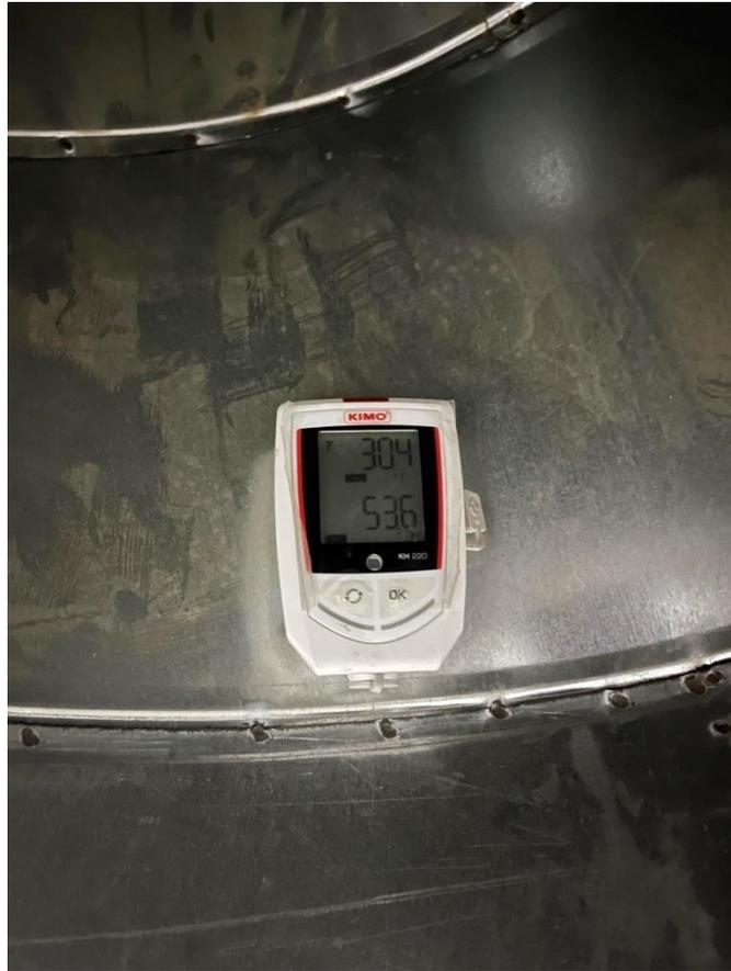
**Figure 3.18 :** Placement de thermo hygromètre dans la canalisation
