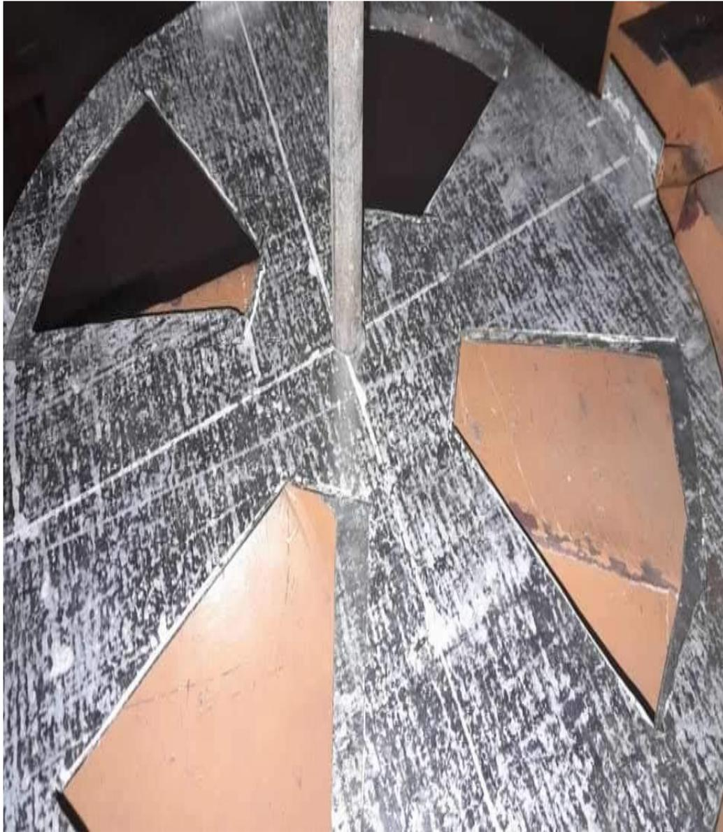
**Figure 3.7 :** Vanne de réglage du débit d'air
