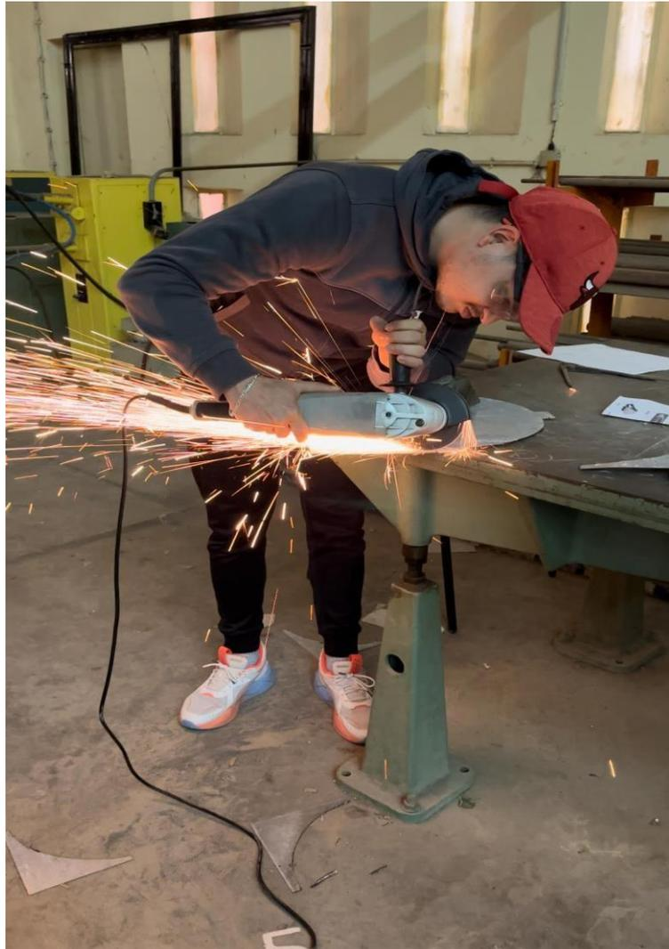
**Figure3.6** : réalisation de la vanne de soufflage au niveau de l'atelier de soudage du département de mecanique
