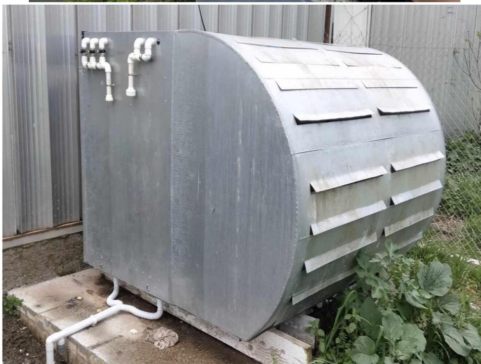
**Figure1.6** : prototype de système de refroidissement évaporatif
