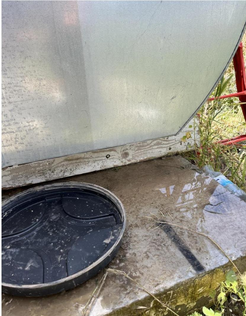
**Figure 3.8 :** fuite d'eau sur le côté du prototype
