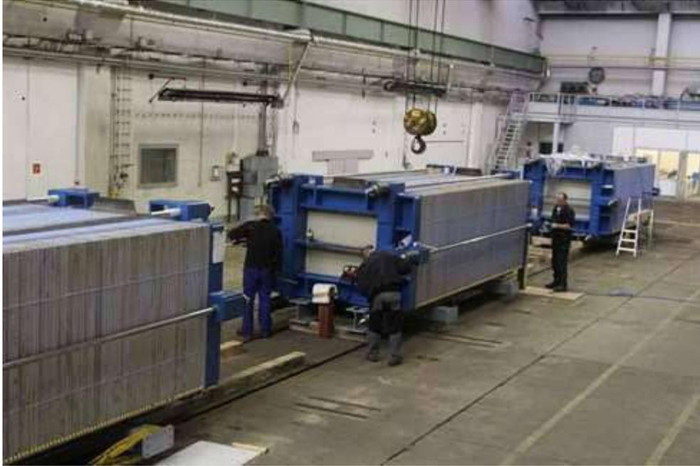
**Figure 2.2** : Trois unités d'électrolyseur alcalin Enertrag de 2 MW unitaire – 1000 m<sup>3</sup>/h [16].
