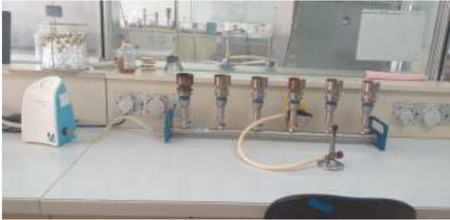
La rampe de filtration avec la pompe et bec bunsen
