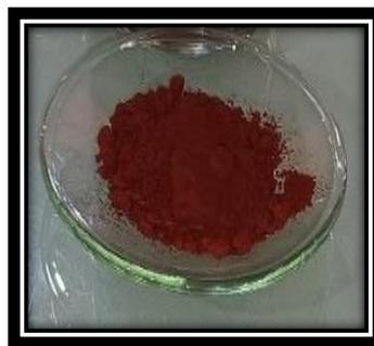
**Figure II. 4:** Aspect visuel d'Oxyde ferrique.
