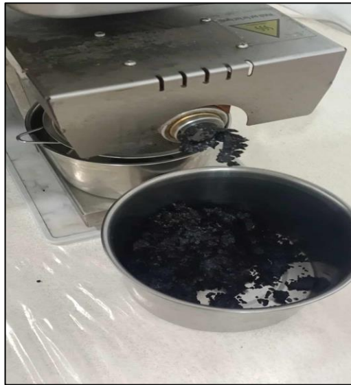
Figure 12: Tourteaux de grains de nigelle, issus de l'extraction par pressage à froid.
