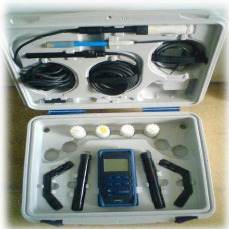
Fig.1:Analyseur multiparamètre de type W.T.W340i
