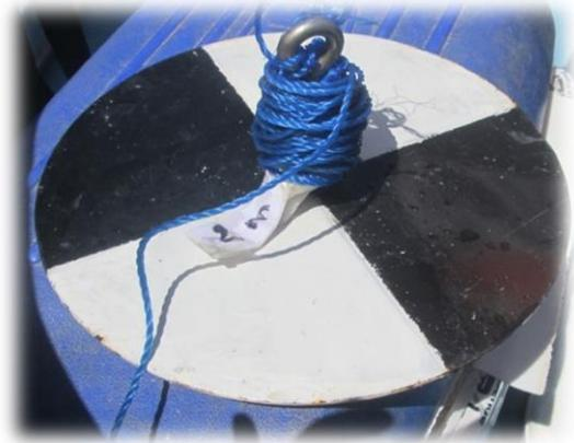
Fig.2:Disque de Secchi
