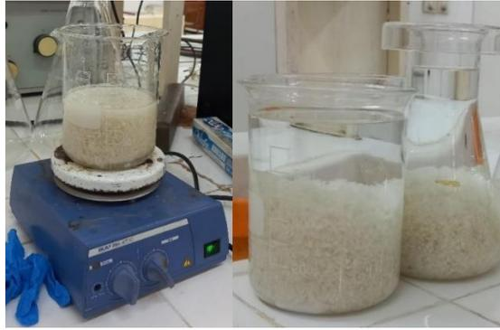
**Figure 2.5.** L'hydrolyse acide.
