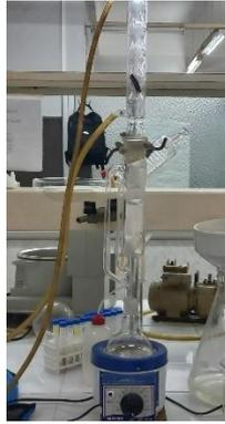
**Figure 2.9.** Montage de soxlhet
