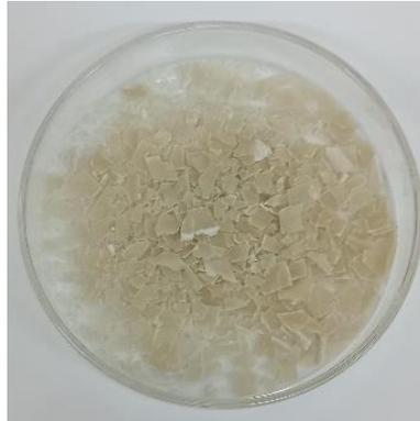
**Figure 2.17.** Membrane composite E7 après le découpage.
