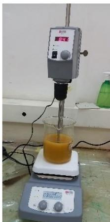
**Figure 2.10.** Traitement basique avec NaOH
