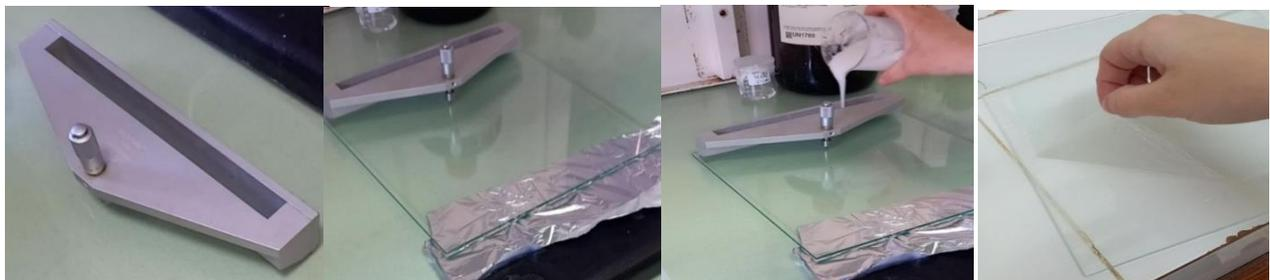
**Figure 2.13.** Les étapes d'étalement avec le couteau de coulé et retraitement de film
