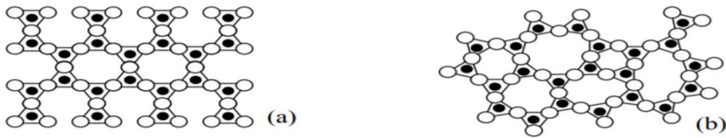
Figure I.3: Représentation plane du réseau de la silice (a) cristalline et (b) amorphe.
