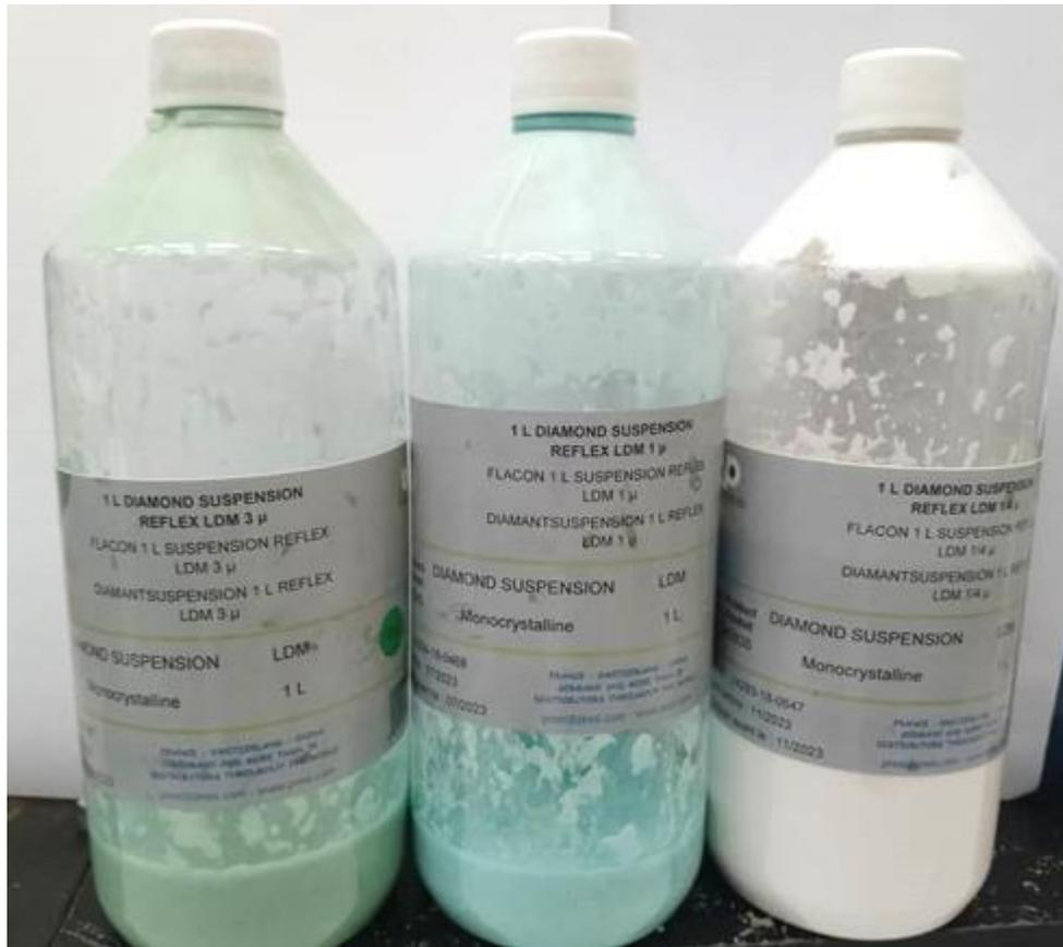
**Figure3- 3** Les solutions diamantées de (0,25, 1 et 3 μm)
