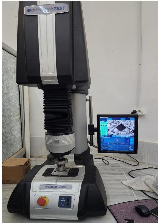
**Figure3- 5** Duromètre de type INVOATEST Nemesis 9100.
