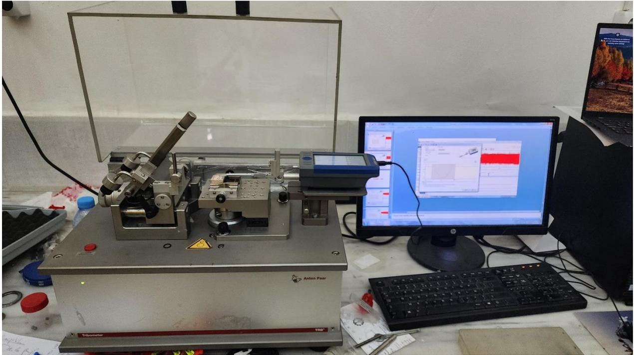
**Figure3- 6** tribomètre type ANTON PAAR TRB3 CSM, switzerland équipé d'un profilomètre 2D
