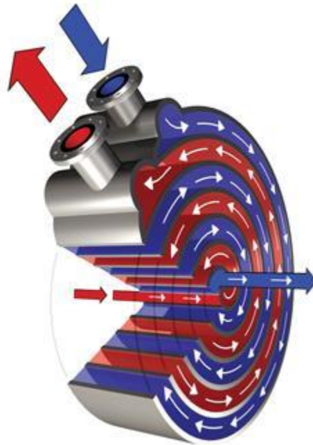
Figure I. 23 : Fonctionnement d'un échangeur spiralé
