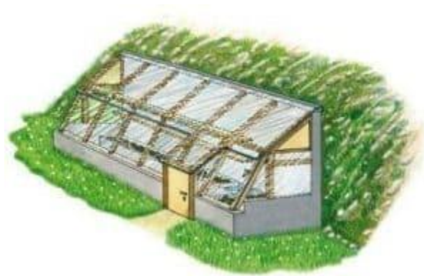
Figure I. 5 : Exemple d'une serre adossée
