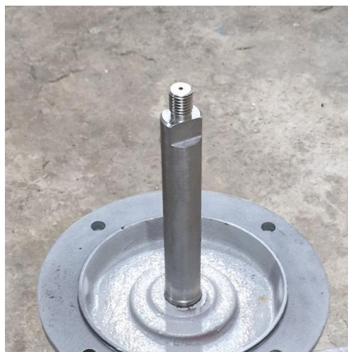
Figure II 14 axe moteur modifié
