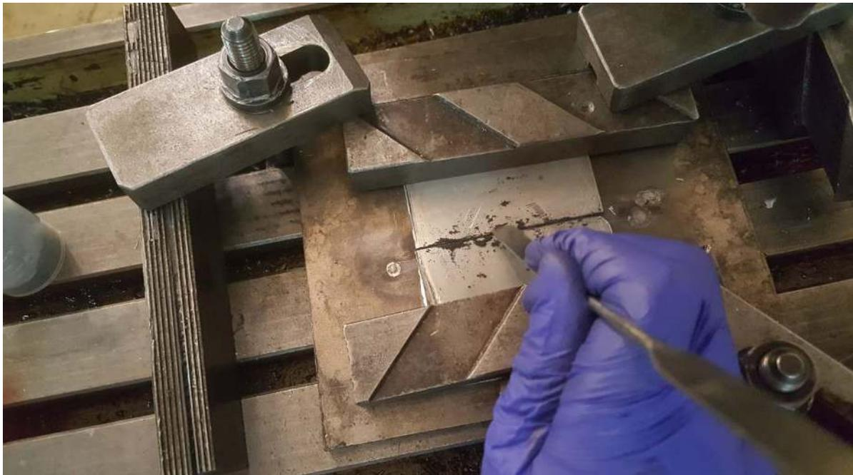
*Figure 23: Addition du renfort en céramiques (eutictique+Cr<sub>2</sub>AlC).*
