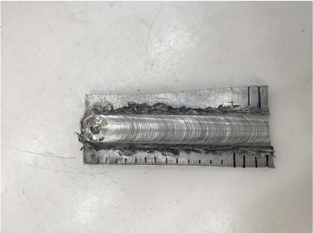
*Figure 26: Des échantillons du 2024-T3 après FSP.*
