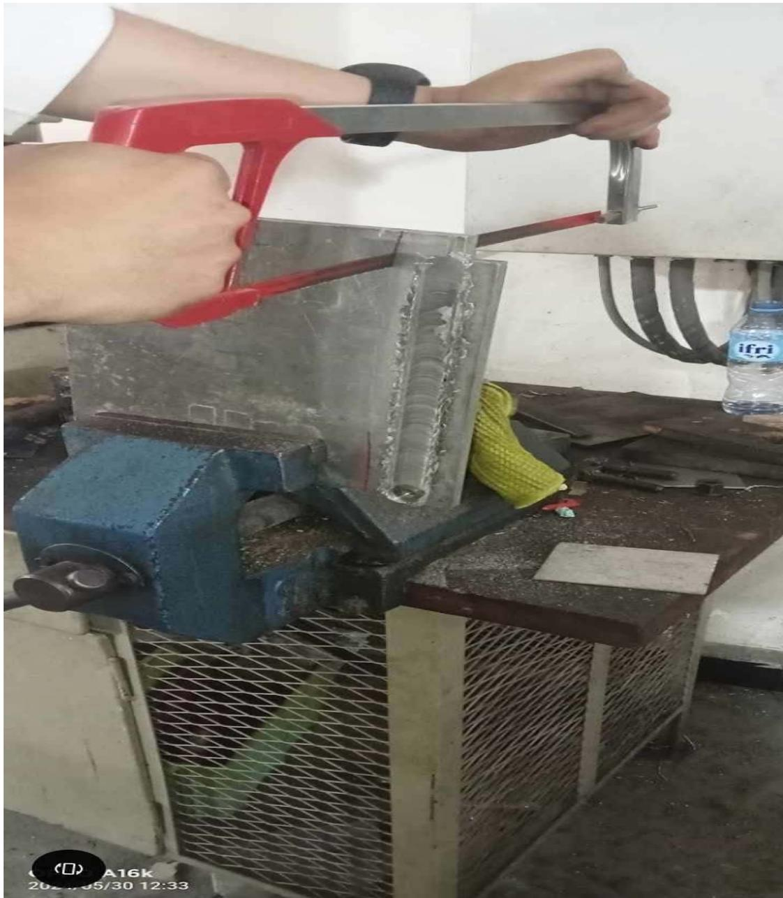
*Figure 27: Découpage de tôle d'aluminium 2024.*
