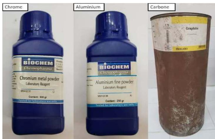
*Figure 15: Poudres utilisées pour la synthèse du Cr<sub>2</sub>AlC.*
