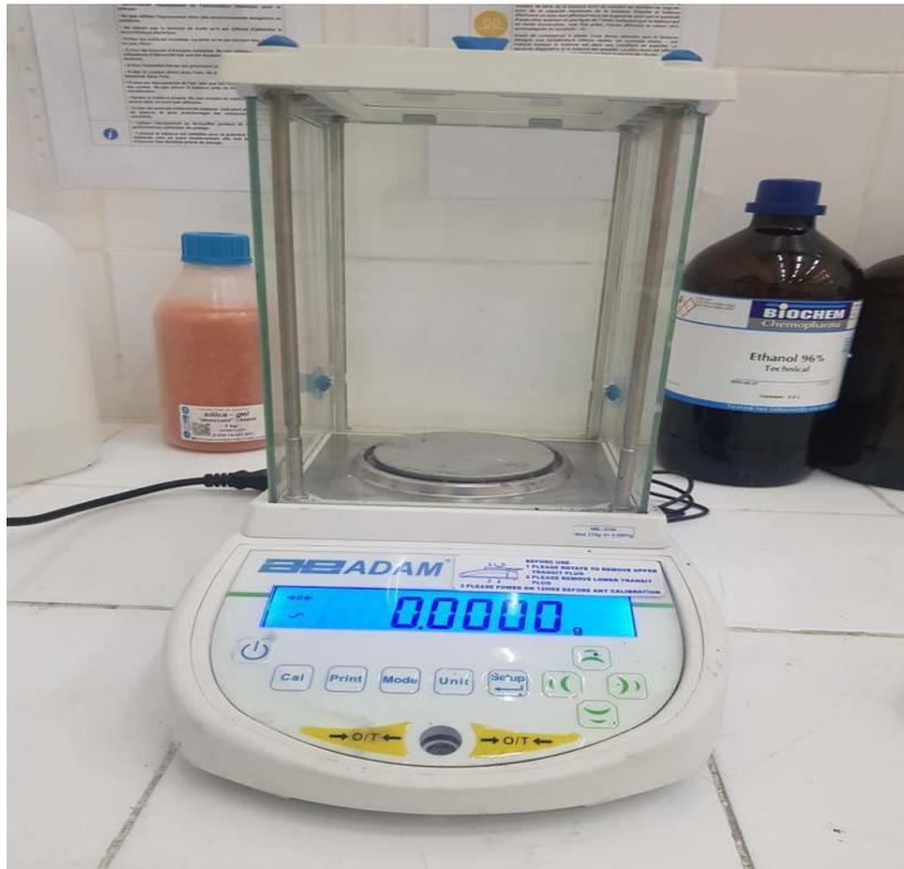
*Figure 16: Balance analytique de précision ADAM.*
