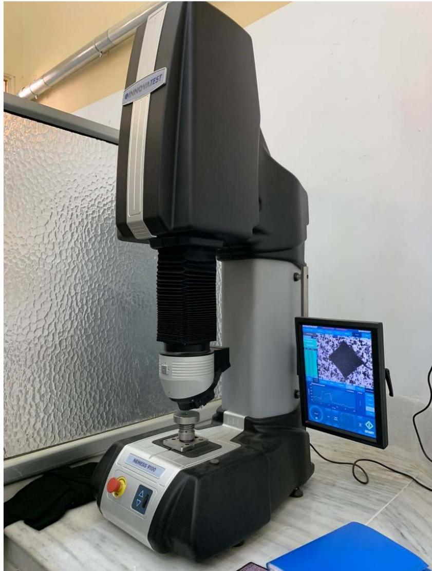
*Figure 34: Le duromètre*
