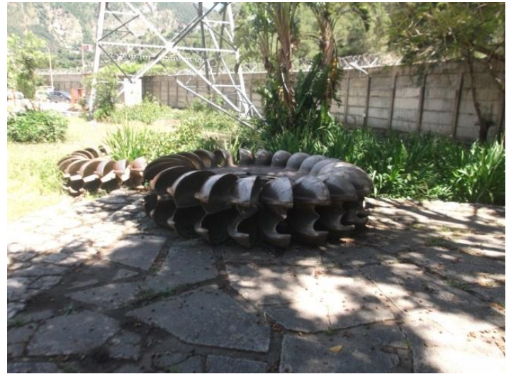
Figure 75 : La turbine Pelton exposé dans le parc de l'usine. (Source : Photo auteur)
