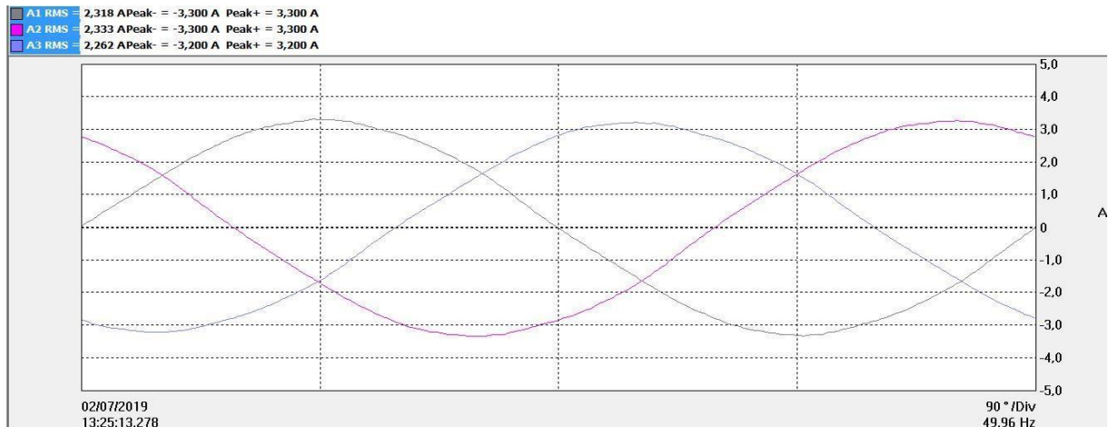
FIGURE 4-4 : REPRESENTATION TEMPORELLE DES COURANTS STATORIQUE EQUILIBRE.
